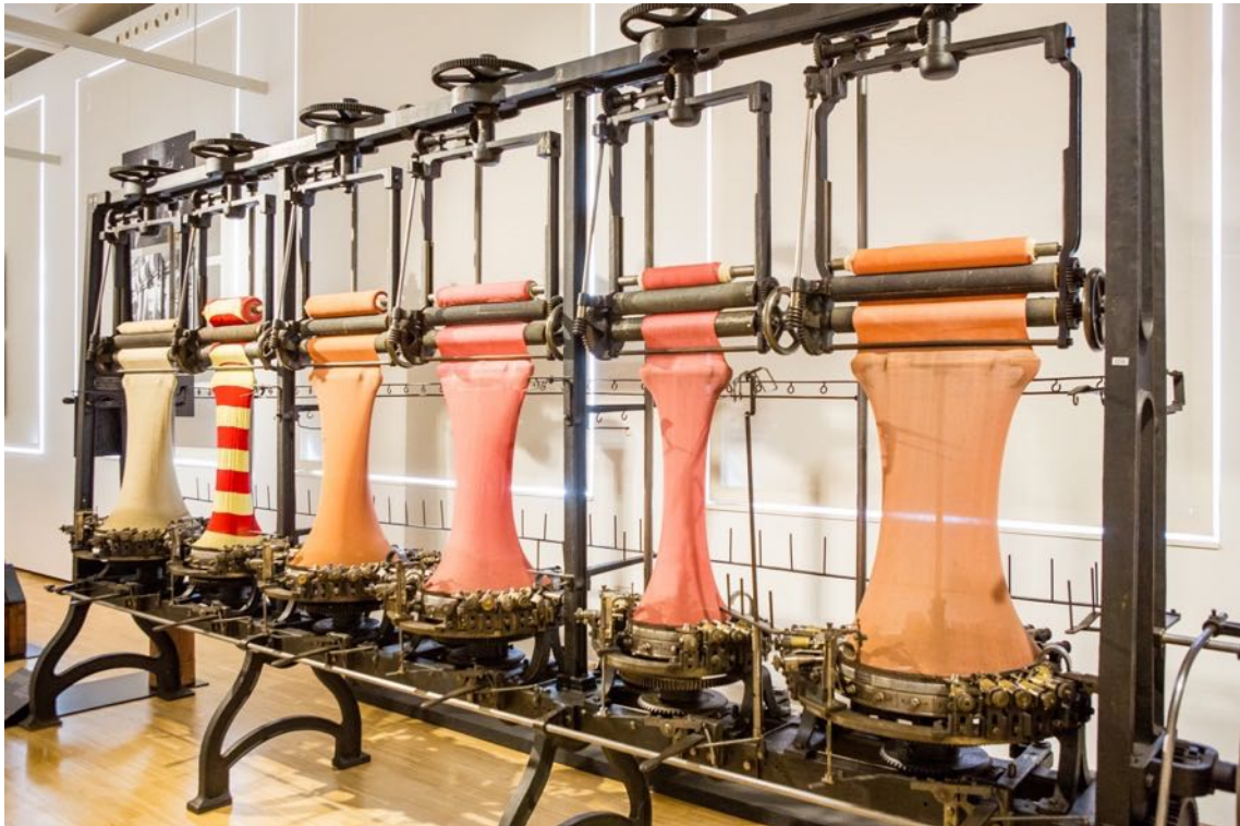
Fig. 3 Bateria de telers circulars de l'any 1930 procedents dels Tallers J. Roure, exposats a Can Marfà Gènere de Punt. Museu de Mataró (Foto: Museu de Mataró. Autor: Pere Masramon).
